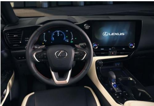
Ein Beispiel dafür sind die Tasten auf dem Lenkrad, deren Funktionen sich nach Fahrerwunsch programmieren lassen. Sobald eine Taste berührt wird, erscheint ihre Form im Head-up Display, sodass der Fahrer nicht aufs Lenkrad schauen muss, um die gewünschte Funktion zu wählen.
